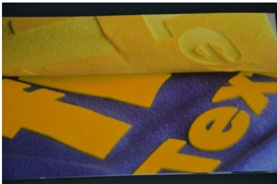
Grundsätzlich lassen sich Transfers mit allen vorgenannten Farbsystemen unter Berücksichtigung von deren spezifischen Vor- und Nachteilen herstellen. Wichtig ist es jedoch, zu wissen, dass sich durch die Auswahl eines geeigneten Transfersklebstoffes die Waschbeständigkeit bis hin zur 90°-Wäsche steigern lässt.
