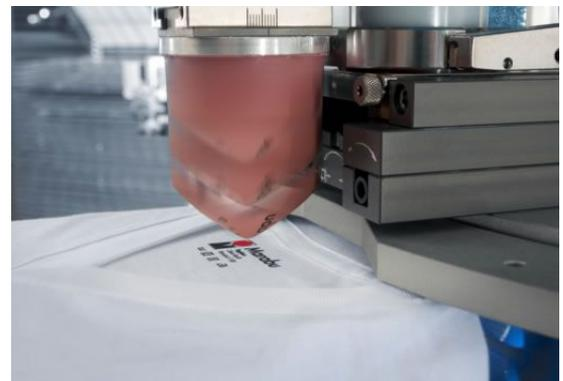
Der Tampondruck kommt zum Einsatz, wenn Textilien keine Einnäher für Angaben wie Waschanleitung, Größe, Hersteller etc. haben sollen (Tagless-Verfahren). Ein geeignetes, sogar Oekotex-zertifiziertes Farbsystem ist die TampaSport TPSP aus dem Hause
