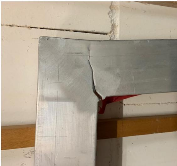
schade eigentlich“ dachte ich mir, denn den **Passer** kann man jetzt vergessen. Genau so war es auch. Der **Siebrahmen** wurde in die Maschine eingebaut, angedruckt und siehe da, die vierte Farbe passte nicht zu den ersten drei Farben.
