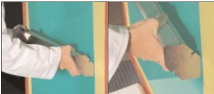
gleichmäßiger Anpressdruck durch Auflage der Endstücke ans Gewebe
