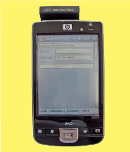
Der Hand-Held ermöglicht das Auslesen und Visualisieren der Daten Sicher und lösemittelfest: Der alltagstaugliche RFID-Transponder Bluetooth-Lesegerät als mobiler Datenspeicher
