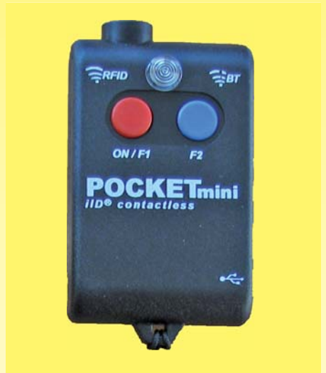
Der Hand-Held ermöglicht das Auslesen und Visualisieren der Daten Sicher und lösemittelfest: Der alltagstaugliche RFID-Transponder Bluetooth-Lesegerät als mobiler Datenspeicher
