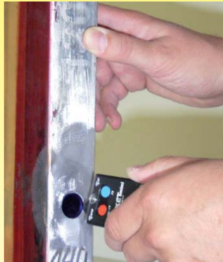
Der Hand-Held ermöglicht das Auslesen und Visualisieren der Daten Sicher und lösemittelfest: Der alltagstaugliche RFID-Transponder Bluetooth-Lesegerät als mobiler Datenspeicher
