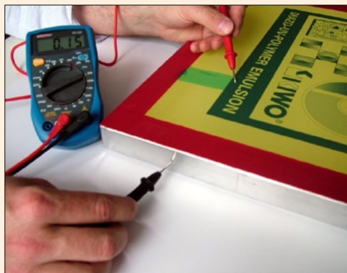
Widerstandsmessung mit Digitalmultimeter: Ableitung der elektrischen Ladung durch Kombination leitfähige Kopierschicht und Siebfüller.
