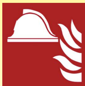
F004 Mittel und Geräte zur Brandbekämpfung
