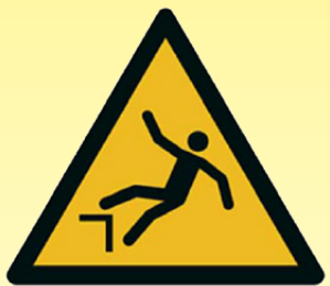
W008 Warnung vor Absturzgefahr
